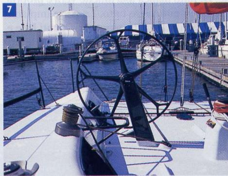
Foto 1 - Vista del lato posteriore del pozzetto. In primo piano la colonna del coffee del verricello self tailing della scotta della randa, sulla sinistra il winch per il paterazzo, al centro le due ruote in fibra di carbonio e, per finire, sullo sfondo il trasto della randa montato sul fondo del pozzetto sulla perpendicolare della fine del boma.
