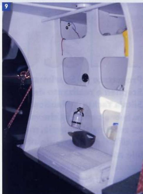
**Foto 1** - La scaletta in composito per l'accesso sottocoperta. Da notare le tre false paratie, con geometria differente in relazione alle sollecitazioni interessate dalla zona di scafo-coperta di pertinenza.
